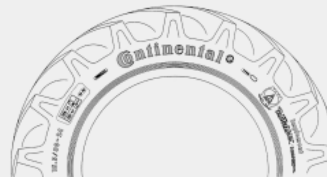
Uspořádání popisu pneumatiky Implement 15,5/80-24 12PR AS Farmer
