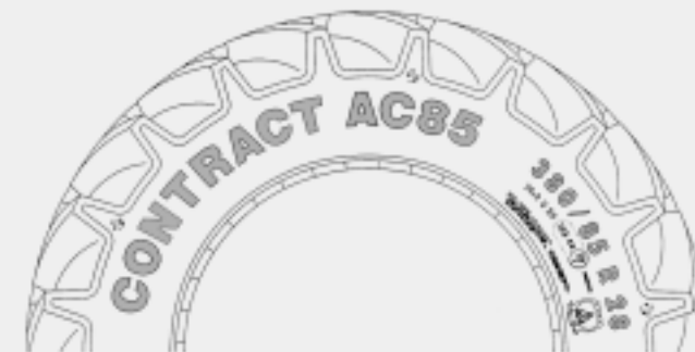
Uspořádání popisu pneumatiky AS-Radial 380/85 R 28 133 A 8 Contract AC 85
